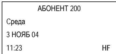
Переключение режима приема вызова HF-PV-TN осуществляется стрелками цифровой клавиатуры, при этом установленный режим отображается в нижнем правом углу дисплея
