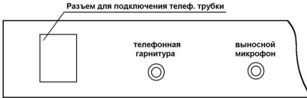
Рис. 1. Разъемы на передней стороне корпуса РЕГИОН-ЦМ
