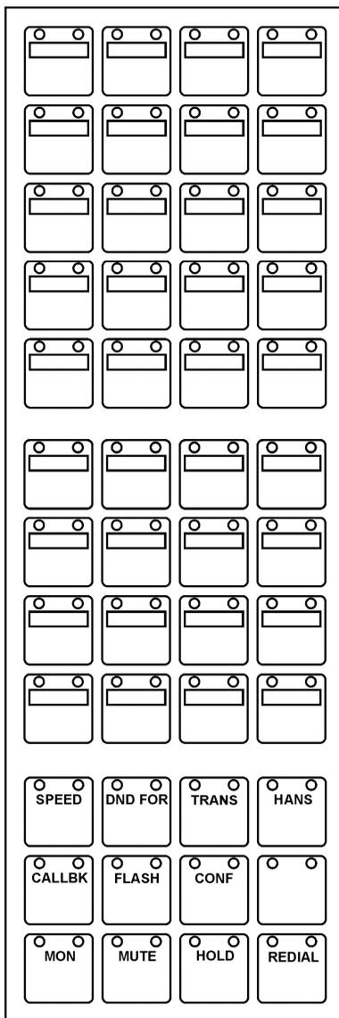
Рис. 7. Расположение клавиш на системном аппарате РЕГИОН-ЦМ.
