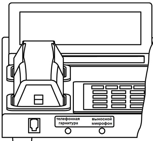
Рис. 2. Разъемы на передней стороне корпуса РЕГИОН-ЦМ
