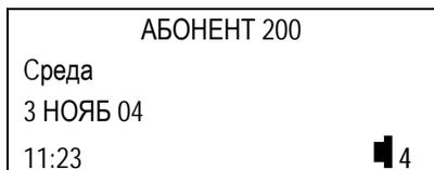
При нажатии клавиши выбора параметра, в нижнем правом углу дисплея отображается символ текущего параметра и его текущее значение
