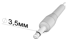
Рис. 4. Двухконтактный штекер разъема для подключения микрофона, магнитофона и акустических колонок.
