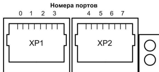
Рис. 20. Разъемы модуля GWSLB7 для подключения абонентских линий
