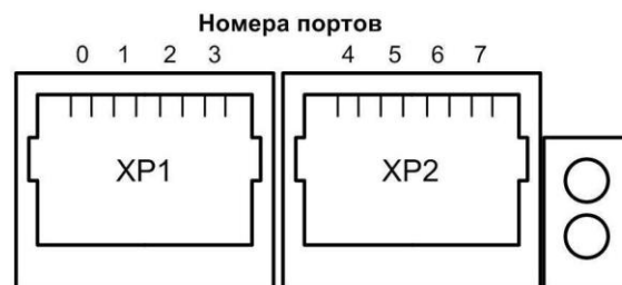
Рис. 3. Разъемы модуля SLB7-08 для подключения абонентских линий
