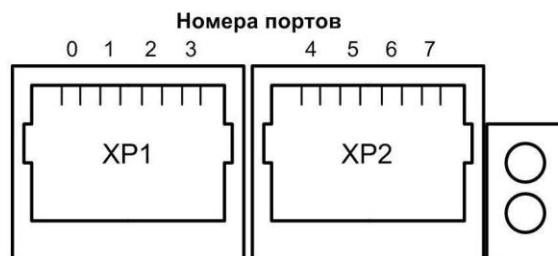
Рис. 20. Разъемы модуля GWSLB7 для подключения абонентских линий
