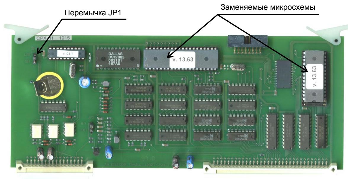
Рис. 4. Расположение элементов на плате CPX-H
