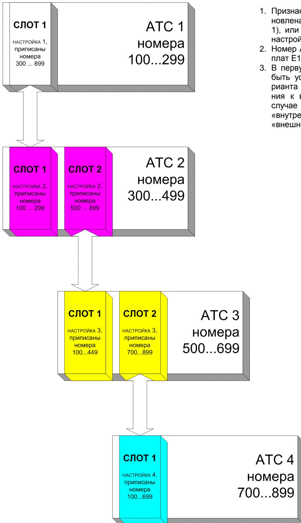
1. Признак такой конфигурации: установлена одна плата E1-XT (на слоте 1), или обе платы одного варианта настройки (2 или 3).
