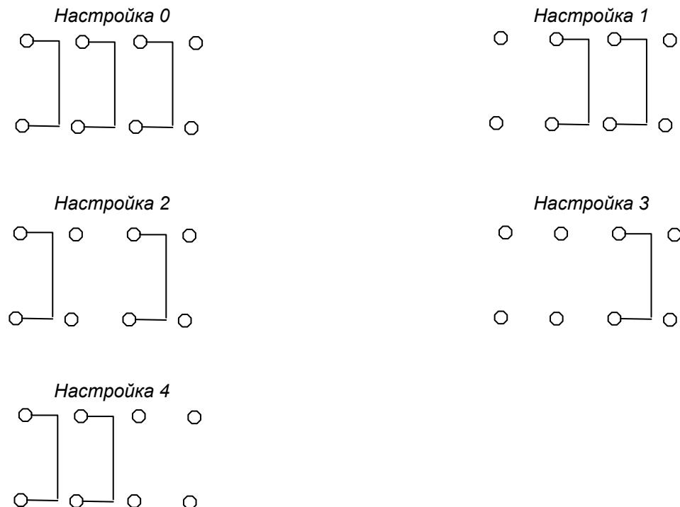
Различия между этими вариантами настройки используются только при самом первом включении станции, для того чтобы определить, по какой из типовых схем АТС объединяются в единое нумерационное пространство (см. следующий раздел). В процессе работы используется лишь тот факт, что настройка этой платы не является настройкой 0.
