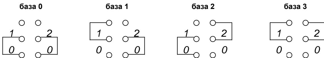
Если база одна, то перемычки JP2 и JP3 не устанавливаются или устанавливаются в верхнее положение.
