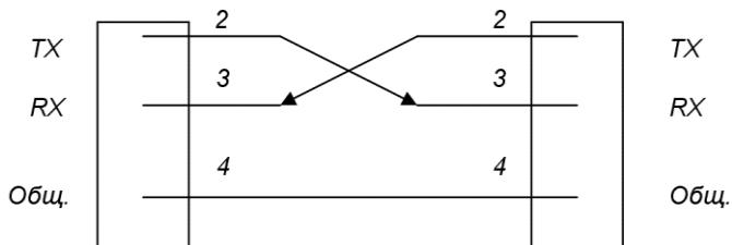
Рис. 6. Схема кабеля для обеспечения транзита с одного потока Е1 на другой
