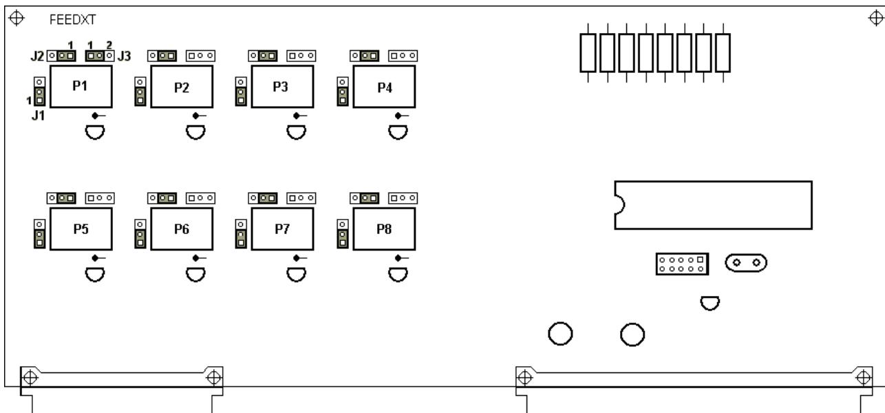
Рис. 7. Схема установки перемычек.
