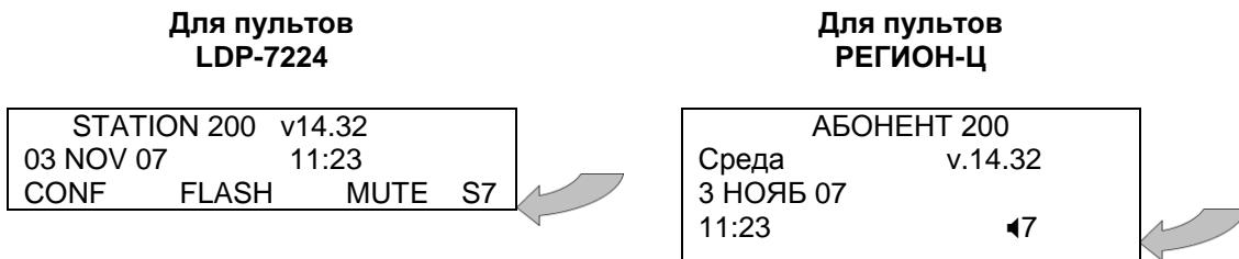
Если на плате внешних линий установлено программное обеспечение с функцией АОН, то все звонки, входящие на станцию по внешним линиям, обрабатываются устройством определения номера звонящего абонента. Если звонок был принят пользователем центрального пульта, в верхней строке его дисплея справа появится номер звонящего абонента и его категория.
