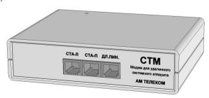
**Важно:** Если к СТМ подключаются одновременно два системных порта, то на станции они должны быть смежными, принадлежащими одной плате KTSL, т.е. порт с нечетным номером и порт с четным номером, на единицу большим нечетного. При подключении только одного системного аппарата, следует использовать гнездо СТА-П.
