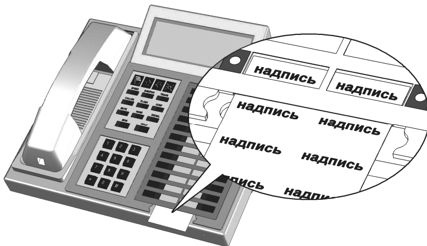
Рис. 6. Информационные надписи клавиш прямого вызова системного аппарата РЕГИОН-ЦЛП.
